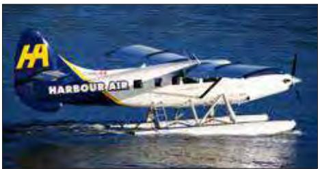
Two de Havilland aircraft that are mainstays of the Harbour Air fleet are the Beaver and the Otter. Both of these aircraft have had their original radial engines replaced with turboprop power. / Deux avions de Havilland, piliers de la flotte de Harbour Air, sont le Beaver et un Otter. Les moteurs radiaux originaux de ces deux appareils ont été remplacés par des turbopropulseurs.
